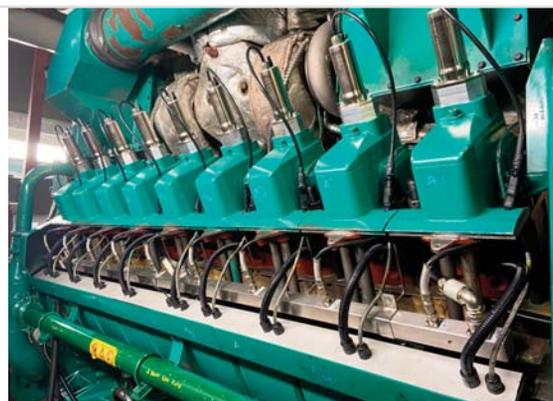
2. После данной модернизации эксплуатант получает полный контроль над агрегатом и может прогнозировать необходимость замены свечей и т.д., не дожидаясь аварийной остановки из-за пропуска зажигания или других процессов в цилиндрах агрегата.
