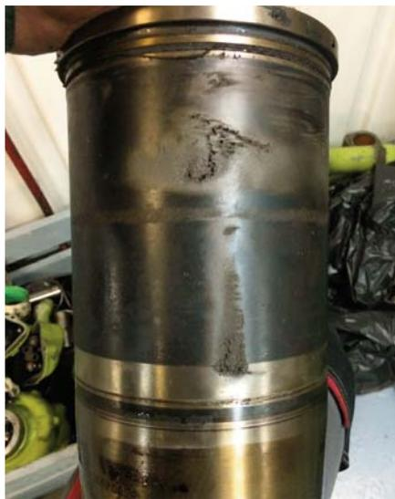
Повреждения гильзы цилиндра вследствие перегрева
