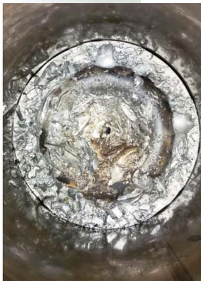
Разрушение поршня в результате детонации
